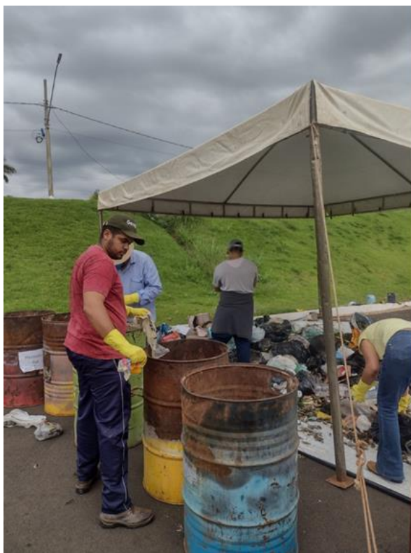
Figura 42. Aferição de massa e volumes de cada tipo de resíduo gerado no estudo de gravimetria em Cachoeira Dourada (MG)
