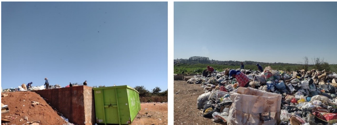
Figura 71 - Separação de resíduos recicláveis na plataforma de descarregamento de resíduos sólidos urbanos na área de transbordo
