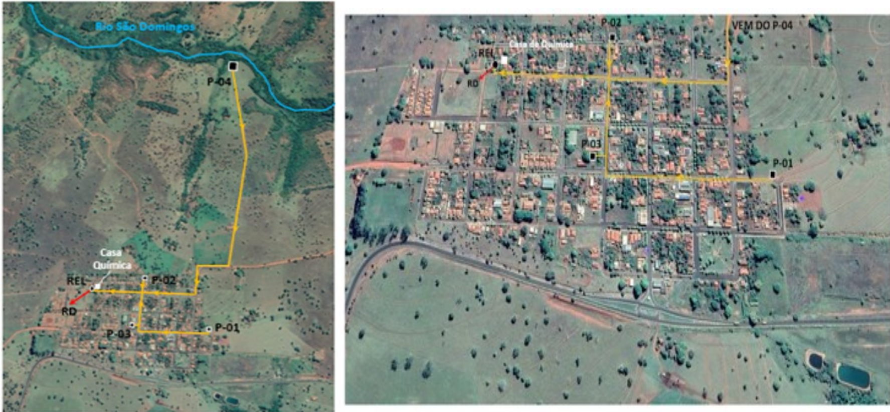
Figura 33 - Sistema de abastecimento de água existente no distrito de Honorópolis
