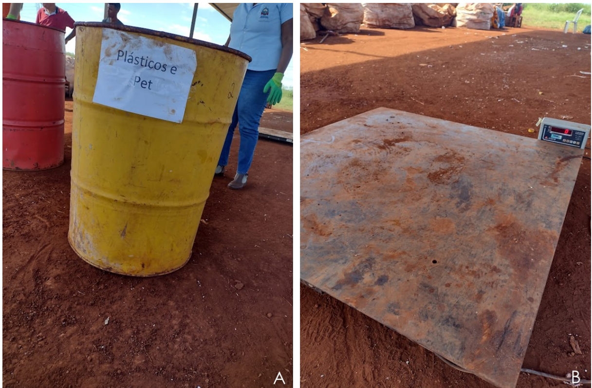
Figura 52. Tambor de 200 L utilizado na aferição de massa e volumes de cada tipo de resíduo (A) e balança de chão utilizada para avaliação gravimétrica dos resíduos domiciliares de Araporã (MG).
